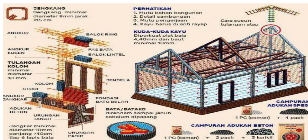
Gambar 2. Standar Minimum Rumah Aman Gempa
