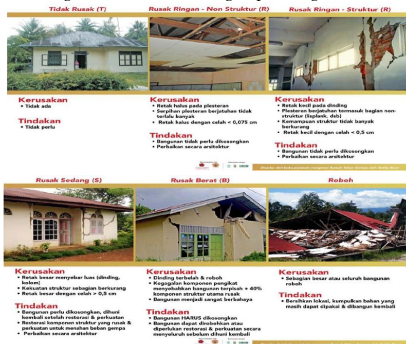
Gambar 11. Kategori Kerusakan pada Rumah Akibat Gempa
