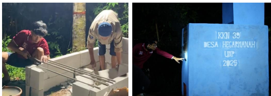
Gambar 1. Pembuatan Rocket Stove dan Uji Coba Rocket Stove
