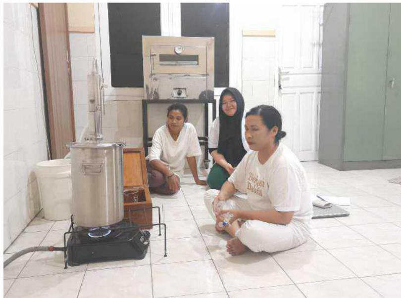
*Gambar 3. Proses Penyulingan Minyak Serai Dapur
