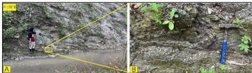
Gambar 15. Singkapan Batulempung Formasi Tapak (Tpt) dengan Azimuth N158°E, (A) Foto Singkapan Jarak Jauh, (B) Foto Singkapan Jarak Dekat
